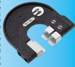
Ces images illustrent un autre type de jauge. La jauge à pression est dotée de quatre enclumes ou mâchoires. La configuration initiale, ou paire extérieure, est ajustée en accord avec la limite supérieure (tolérance) de la pièce, tandis que la paire intérieure est ajustée en fonction de la limite inférieure de la pièce.
